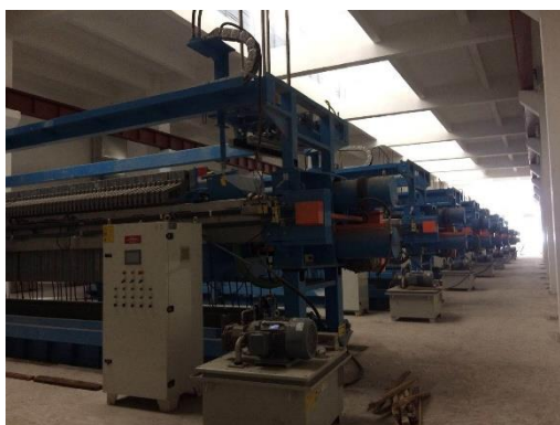
已建成的板框压滤设备
