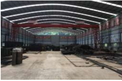
钢筋加工采取全密闭措施
