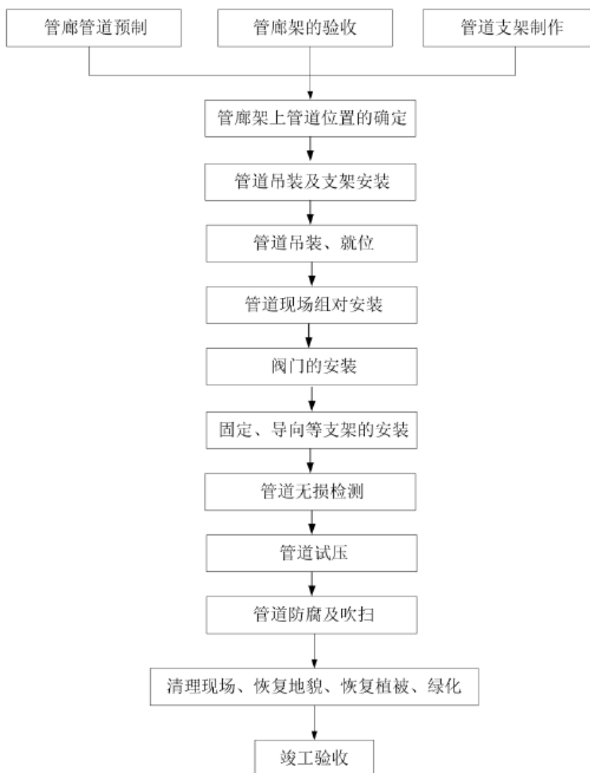
图 3.1-2 项目管廊施工总体工艺图
