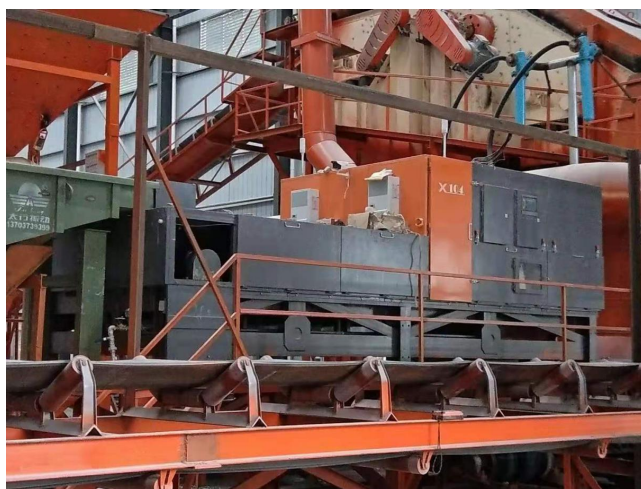
图 5.4-1 光电分选高压气喷系统收尘措施示例图
