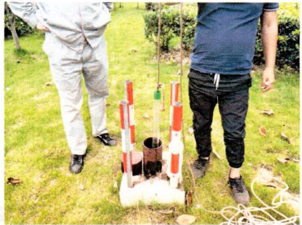
1#地下水监测井（☆1）
