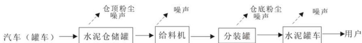
图 3.6-8 水泥运输罐车输送流程图
