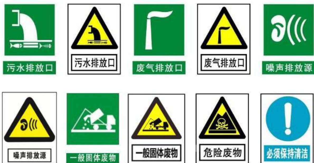
图 9.2-1 排污口图形标志示意图
