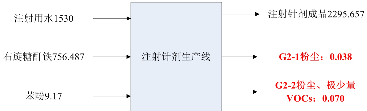
图 4.3- 3 注射针剂单批次产品物料平衡图（单位：kg/批）
