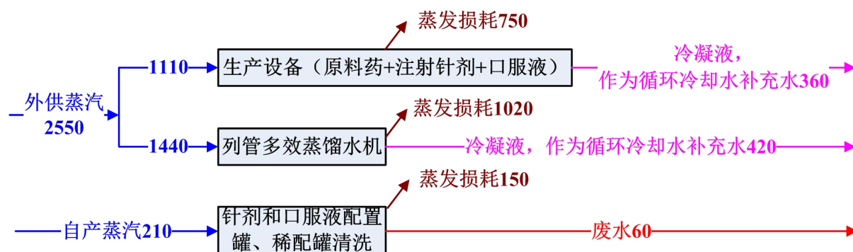
图 4.4- 9 本项目蒸汽平衡图（单位：m3/a）
