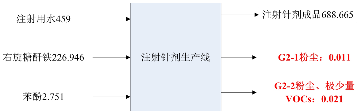
图 4.3- 4 注射针剂年产品物料平衡图（单位：t/a）
