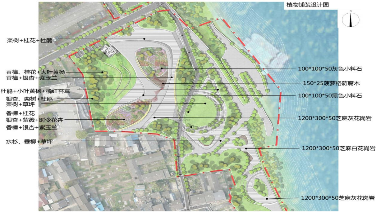
图 3.3-6 红花套镇滨江生态修复工程分区一种植及铺装设计图
