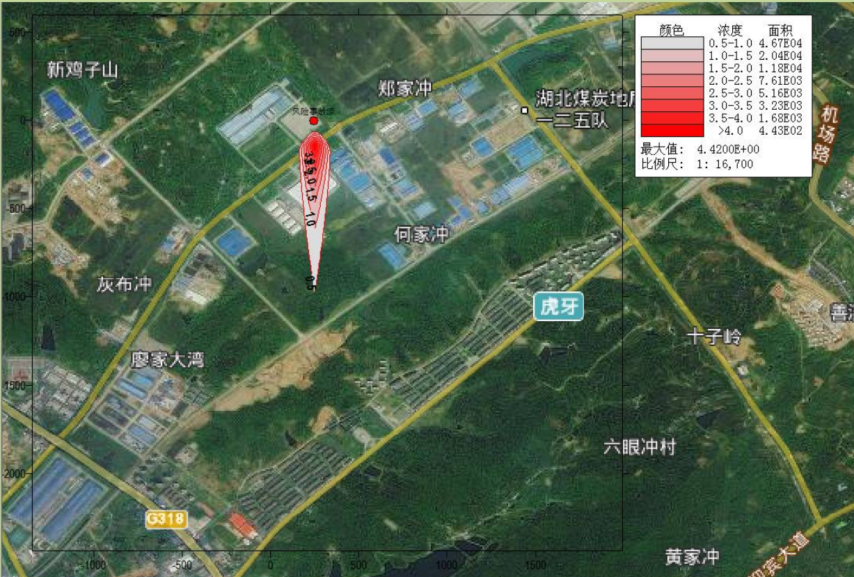
图 6.6-3 甲醇贮槽泄漏事故预测结果图
