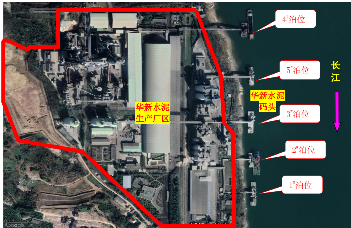
图 2.2-1 码头泊位布局示意图
