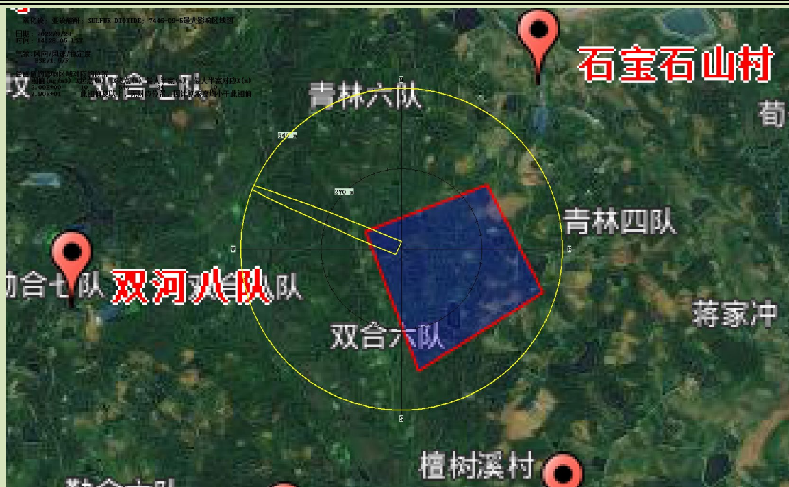
图 6.6-1 液体二氧化硫储罐泄露风险预测结果图 (最不利气象条件)
