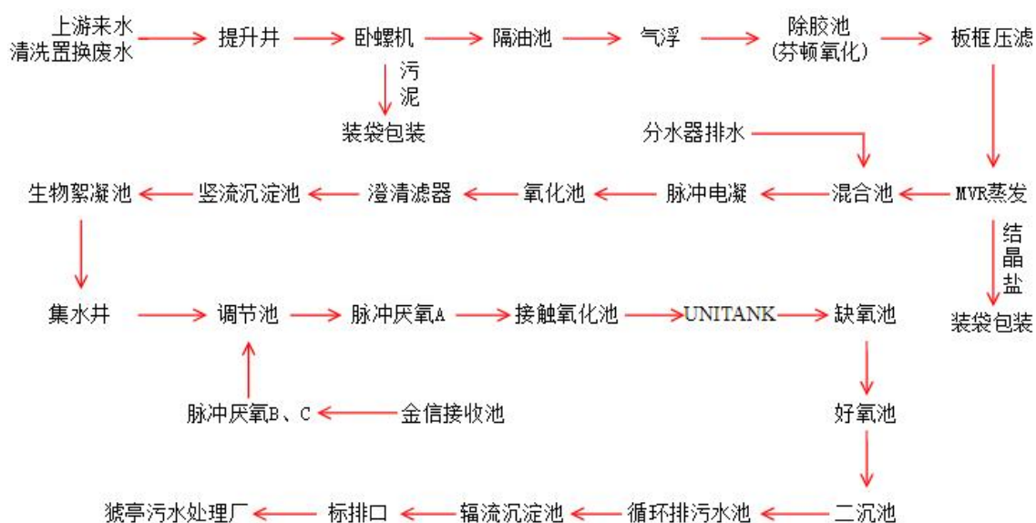
图 7.2-1 兴瑞公司有机硅污水处理站工艺流程示意图
