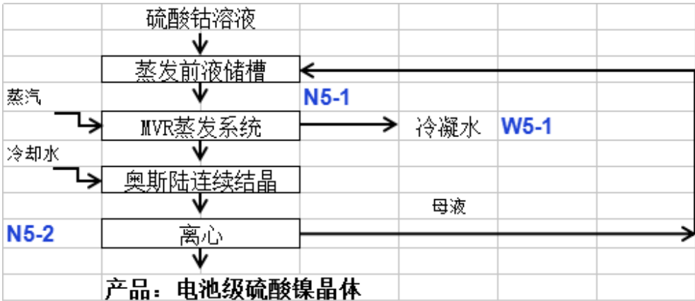
图 3.6.5-1 电池级硫酸钴晶体生产工艺流程及产污环节图
