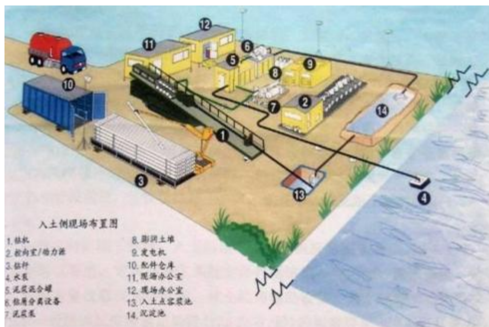
图 4.1-5 定向钻施工钻机场地平面布置图
