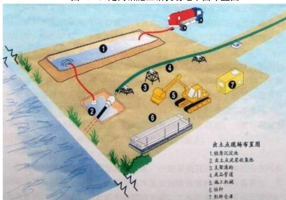
图 4.1-5 定向钻施工钻机场地平面布置图
