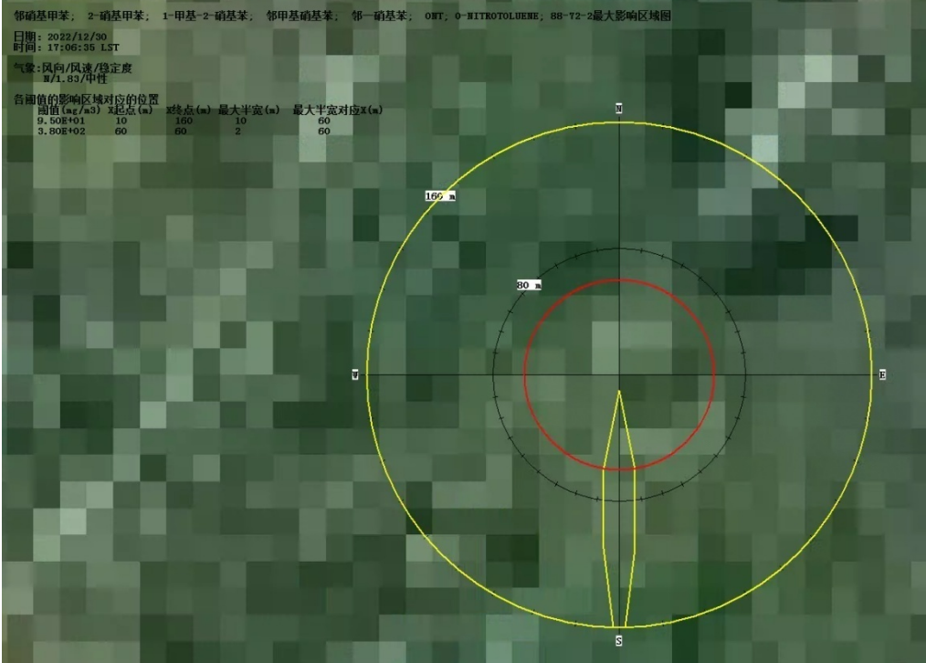
图 8.8-2 邻硝基甲苯泄漏引发火灾次生 CO 环境风险预测结果图
