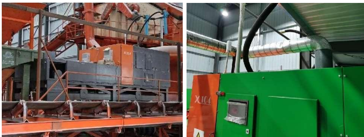
图5.5-1 光电选矿设备高压气喷系统收尘措施示例图
