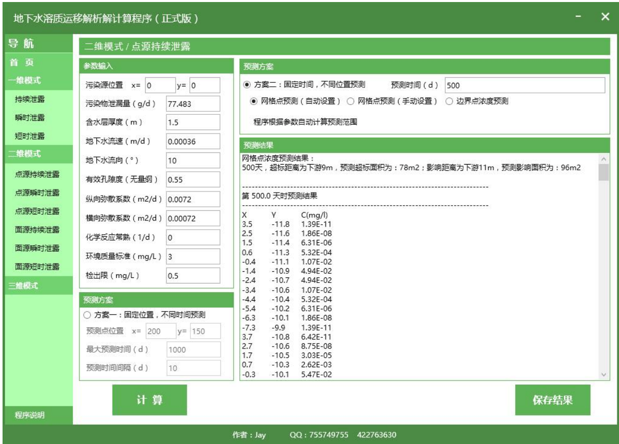
图 4.2-7 非正常渗漏 500d 时污染物 COD 在地下水中的运移预测截图
