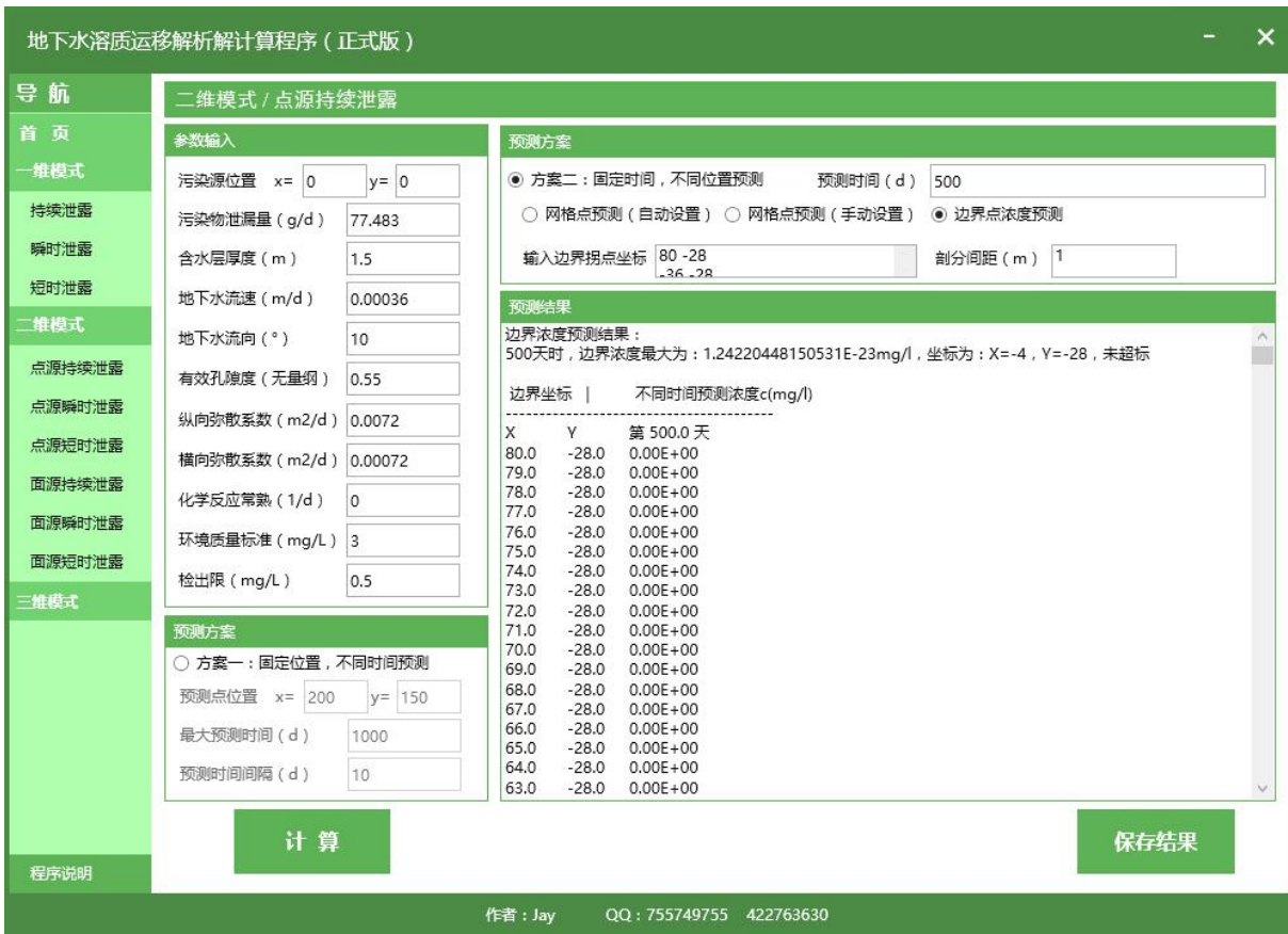
图 4.2-10 非正常渗漏 500d 时场地边界处地下水中污染物 COD 的预测截图
