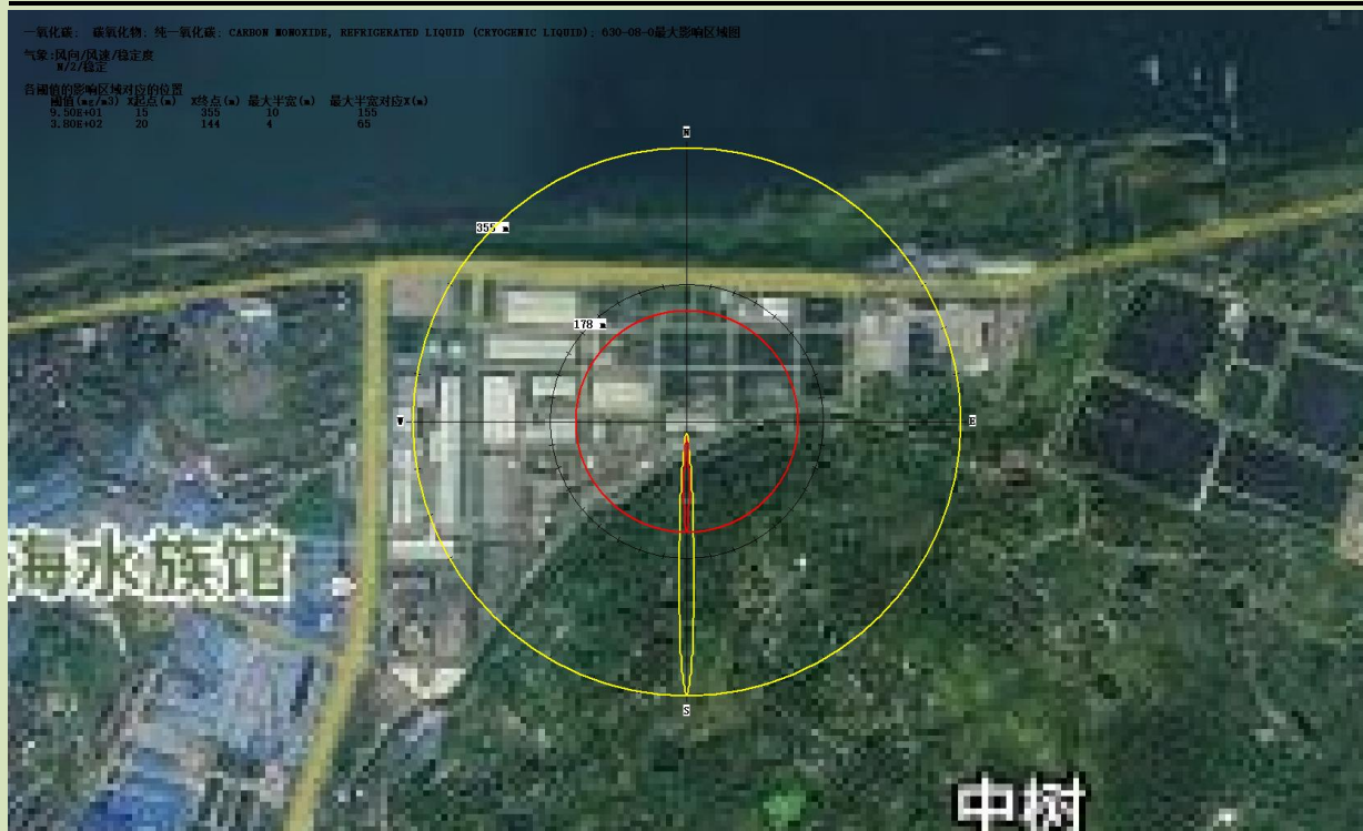
图 6.6-7 环氧氯丙烷泄露火灾次生 CO 扩散环境风险预测结果图
