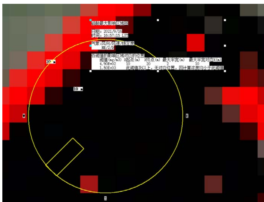
图 6.6.1-2 硫酸储罐泄露影响范围图（常见气象条件）
