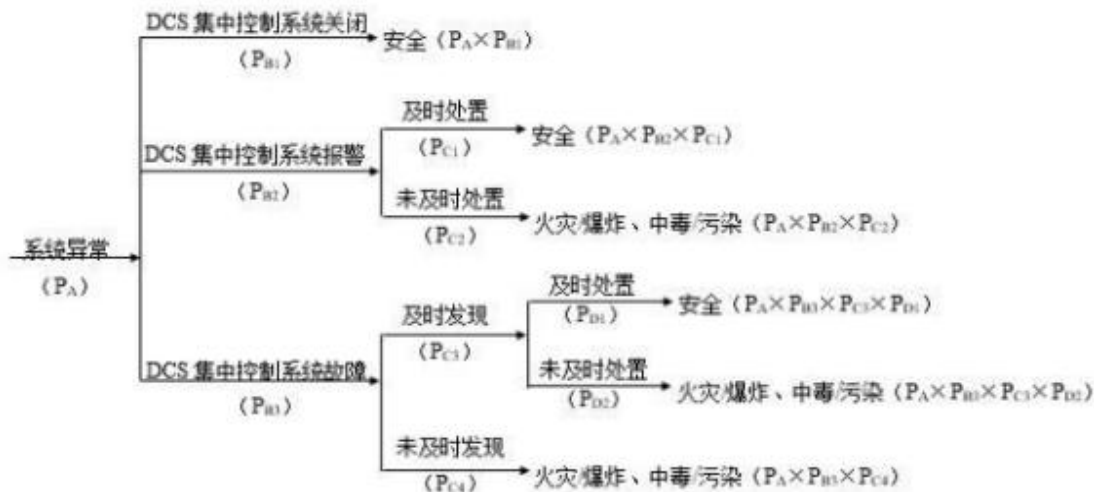
图 5.9-2 项目储存系统事故树分析
