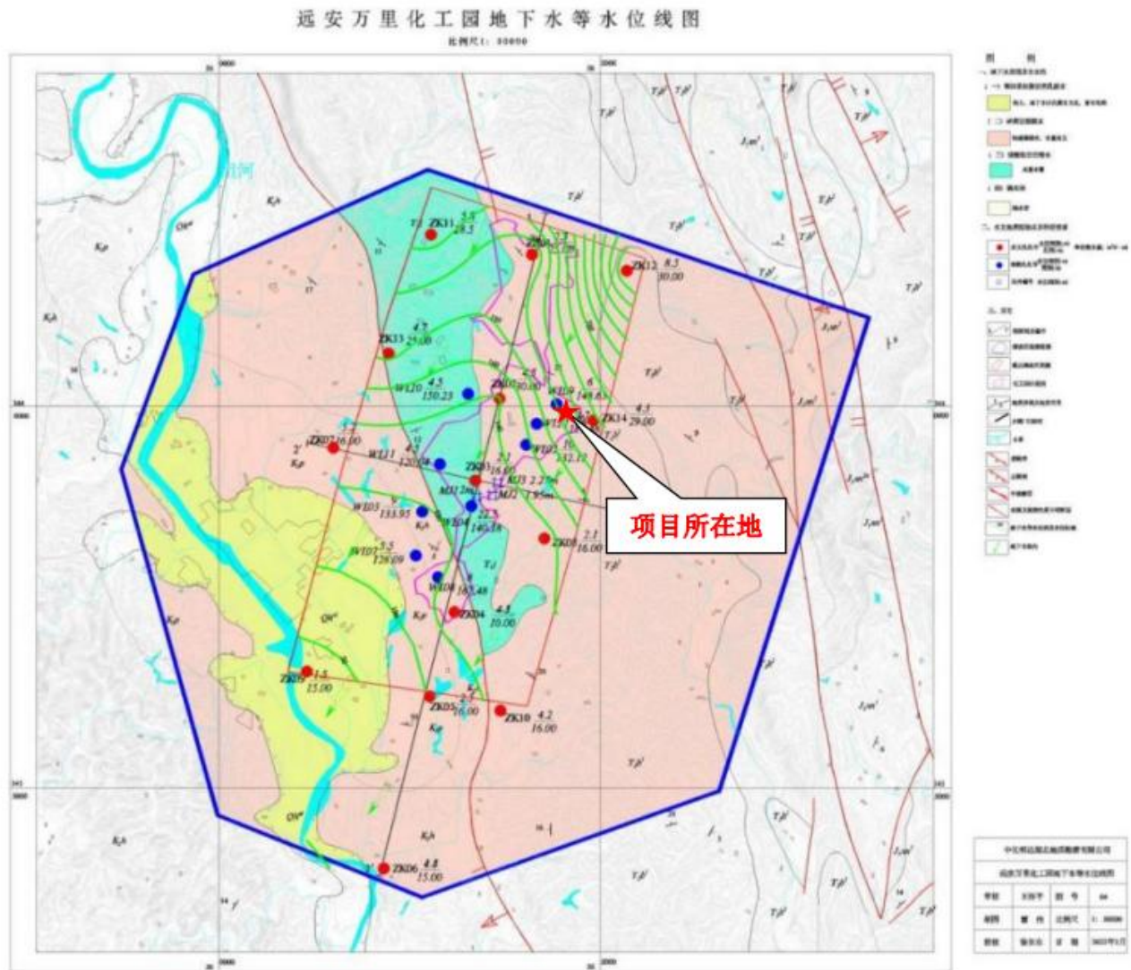
图 5.6-3 万里化工园地下水等水位线图
