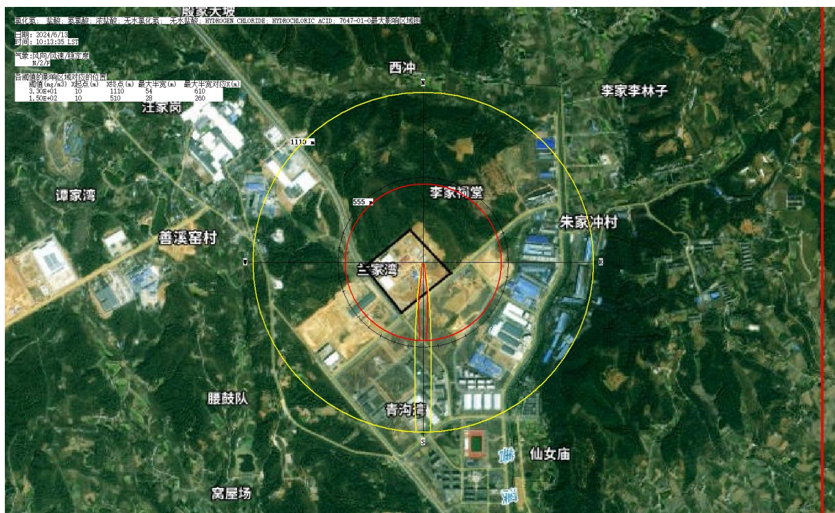
图 8.7-1 盐酸储罐泄露 HCl 扩散环境风险预测结果图
