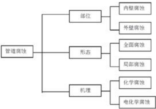
图 7.4-1 管道腐蚀类别
