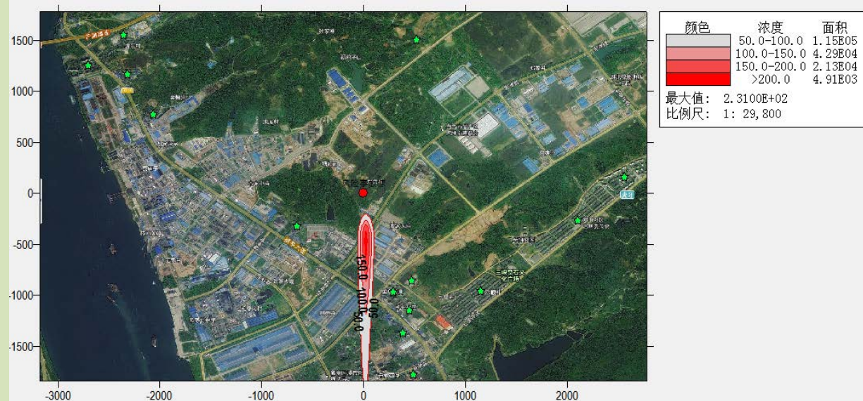
图 6.6-1 废稀硫酸储罐的二氧化硫泄漏事故预测结果图
