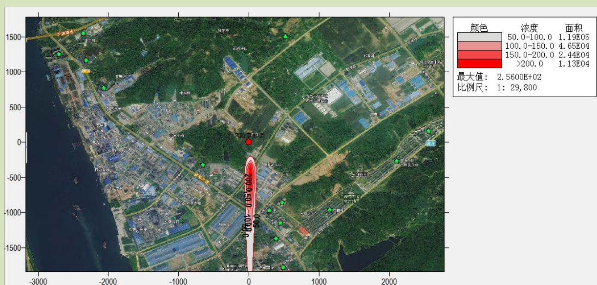
图 6.6-2 二吸塔装置的二氧化硫泄漏事故预测结果图
