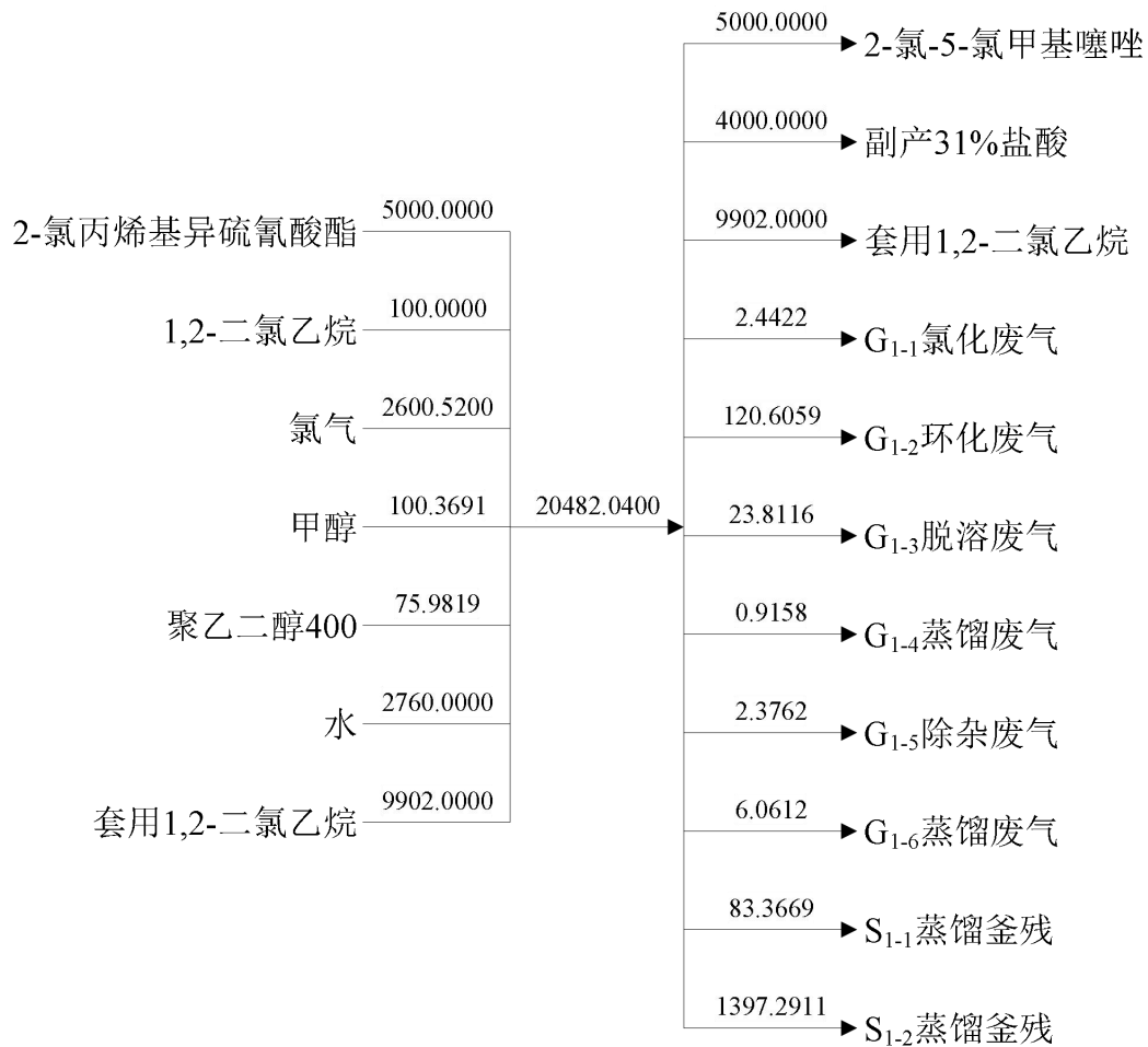
图 4.2.2-1 2-氯-5-氯甲基噻唑总物料平衡图 (t/a)
