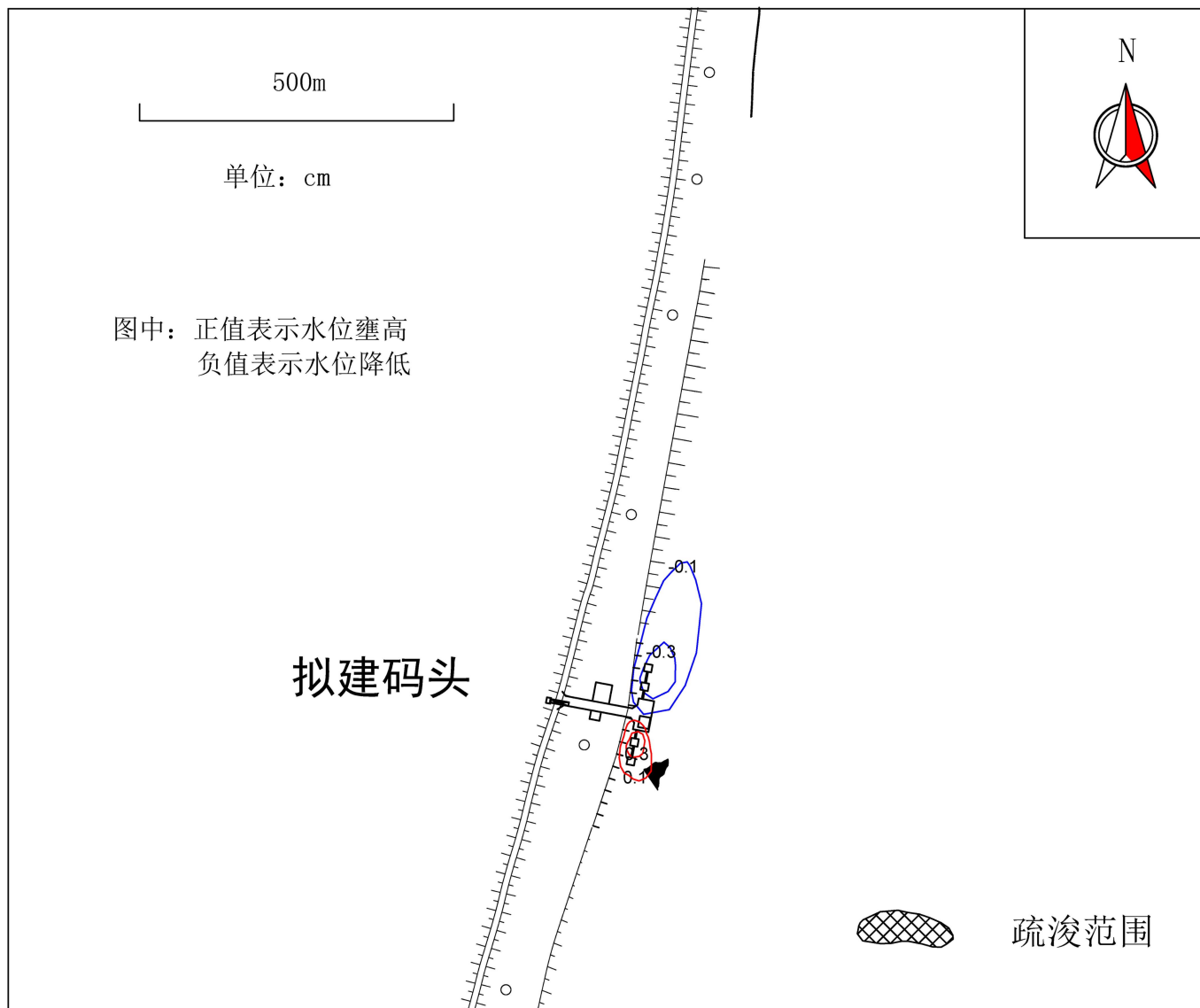
图 5.1-5 丰水期水位变化
