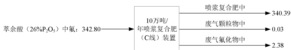
图 4.2.4-29 喷浆复合肥（C 线）装置氟平衡（t/a）
