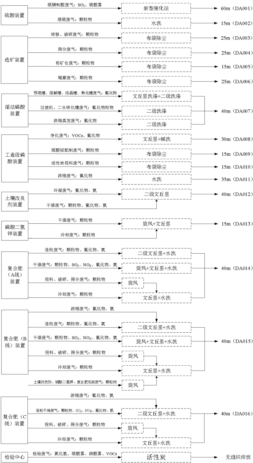
图 8.2.1-1 项目废气收集处理流程示意图
