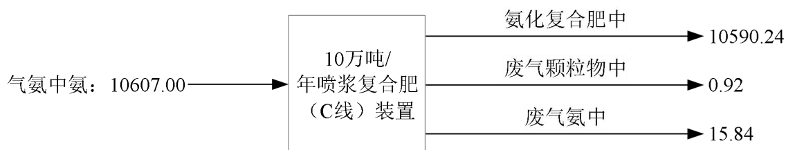
图 4.2.4-30 喷浆复合肥（C 线）装置氨平衡（t/a）
