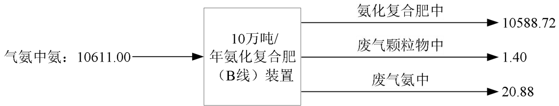
图 4.2.4-26 氨化复合肥（B 线）装置氨平衡（t/a）
