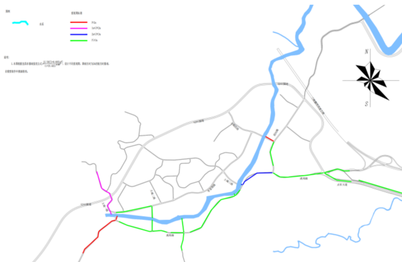
图 6.3-4 点军片区现状排水管网（考虑海绵城市径流控制率）排水能力评估图
