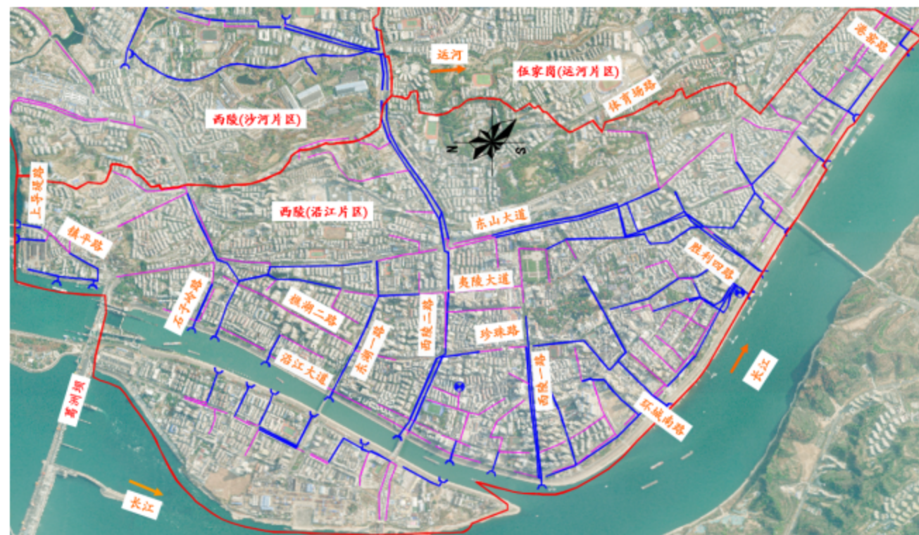
图 2.3-2 西陵—沿江片区主干管分布平面图
