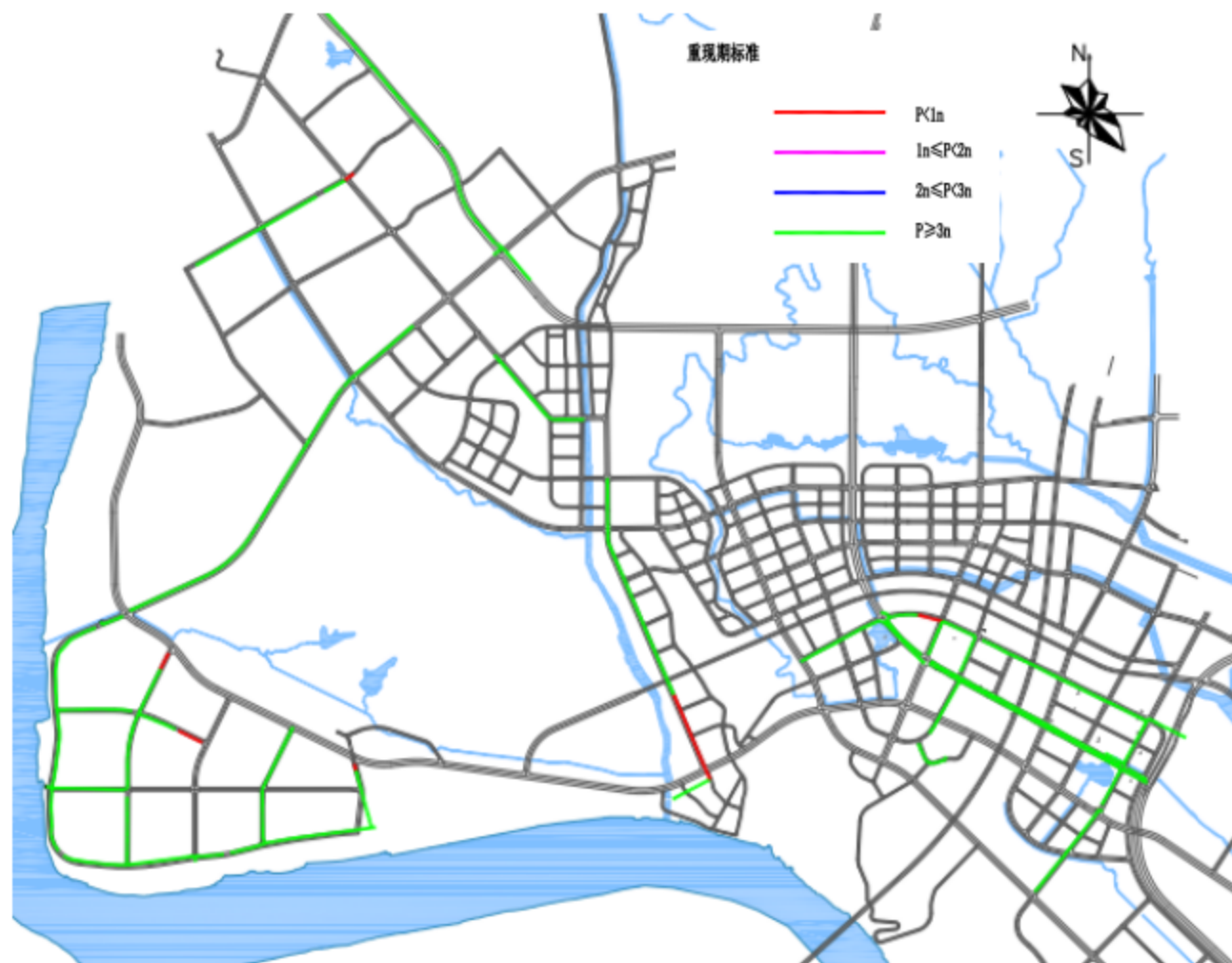
图 6.3-6 沙湾片区现状排水管网（考虑海绵城市径流控制率）排水能力评估图
